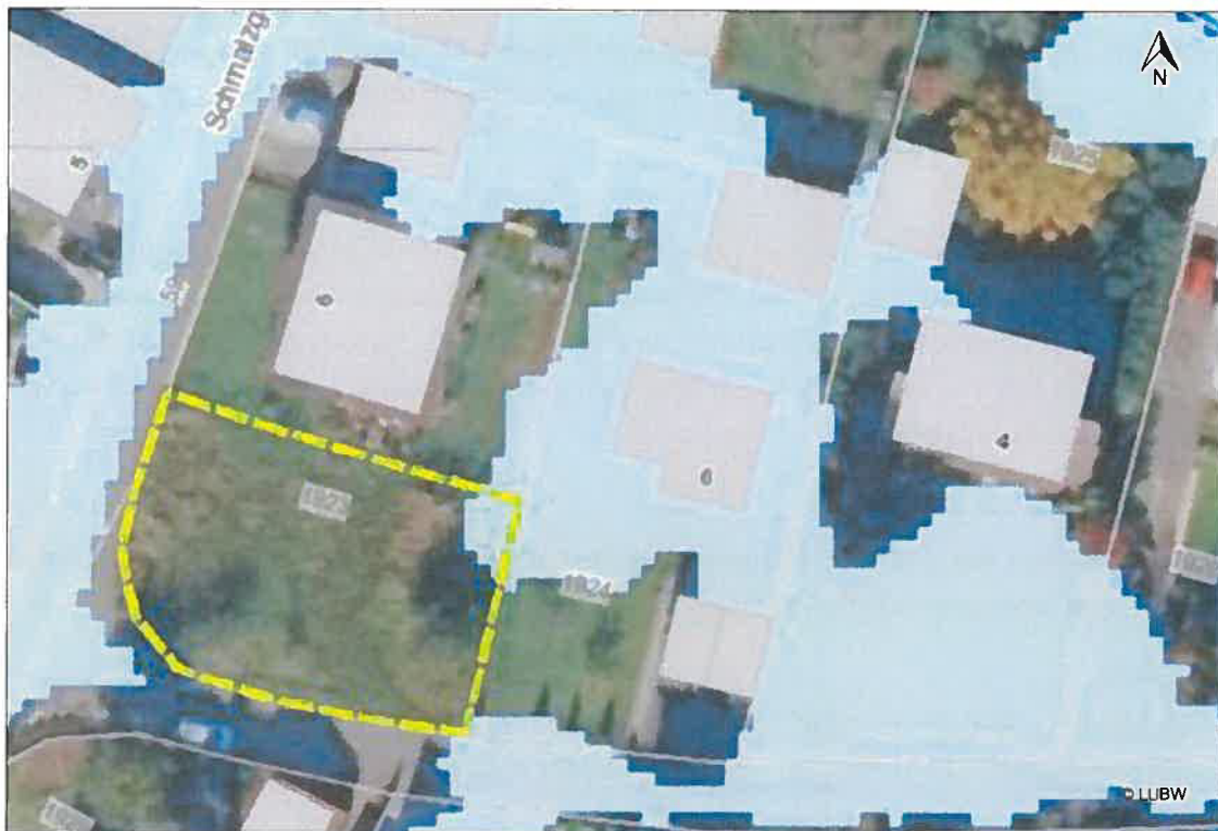
Abb.2: Darstellung des bei einem Hochwasser HQ extrem betroffenen Bereichs der Planfläche.
